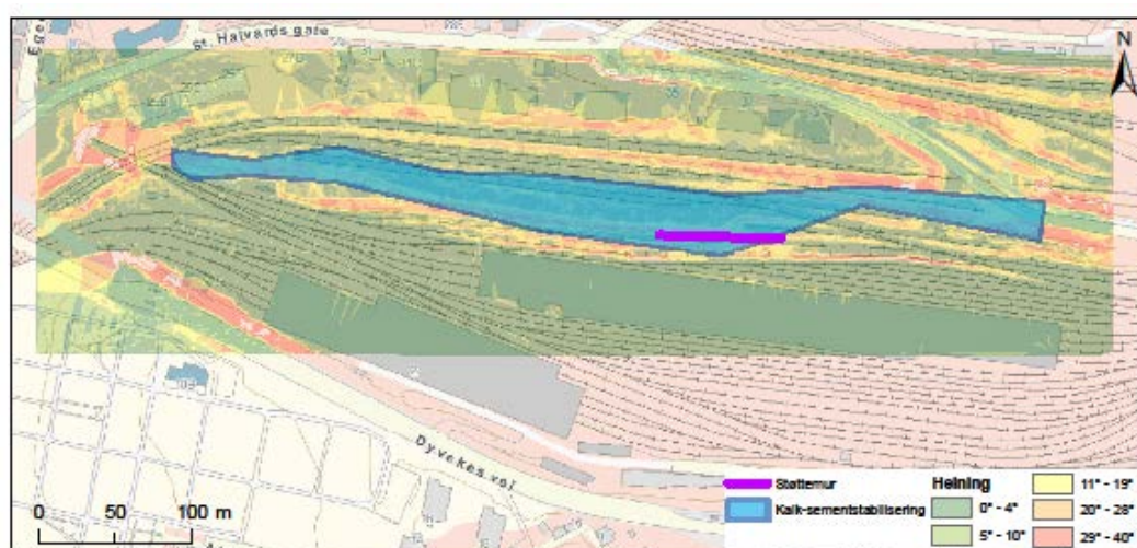
Figur 6.1 Foreslått område av kalk-sementstabilisering og støttemur
