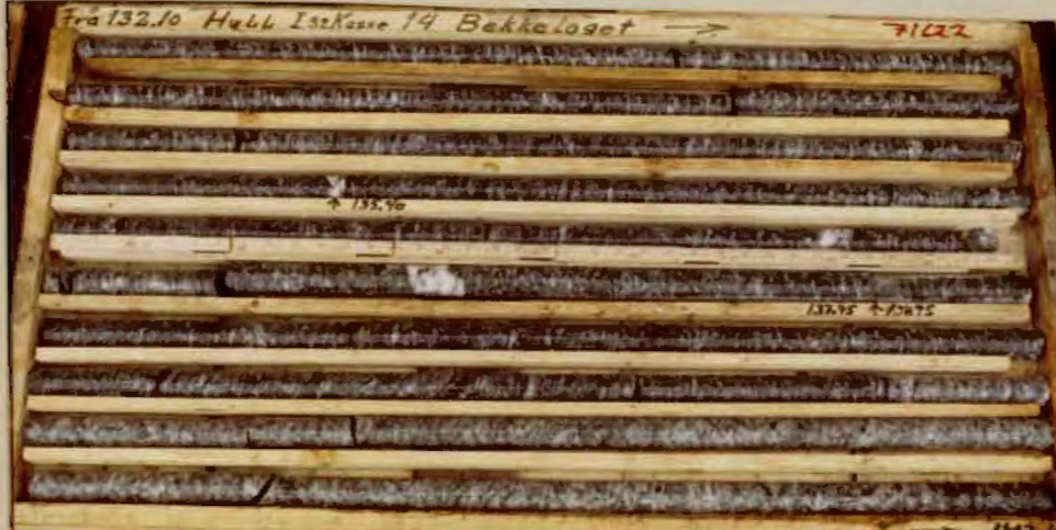
Kasse 14. 132, 10-142, 10m. Gjennomsnittlig RQD=100% Min. RQD=97% (137, 10-138, 10).
