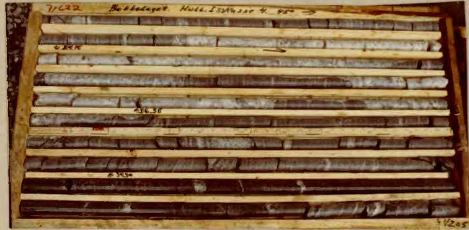
Kasse 4. 32, 10-42, 10m. Gjennomsnittlig RQD=85% Min. RQD=72% (33, 10-34, 10).
