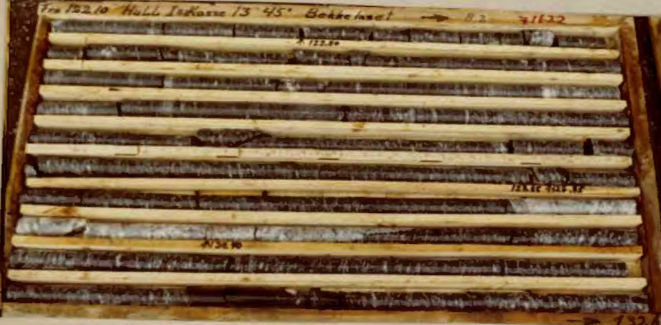
Kasse 13. 122, 10-132, 10m. Gjennomsnittlig RQD=93% Min. RQD=67% (122, 10-123, 10).
