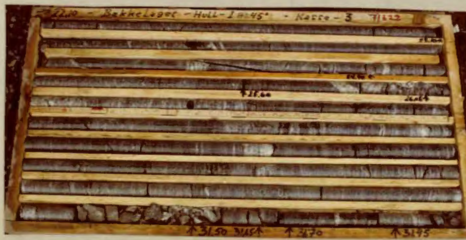
Kasse 3. 22, 10-32, 10m. Gjennomsnittlig RQD=78% Min. RQD=43% (31, 10-32, 10).
