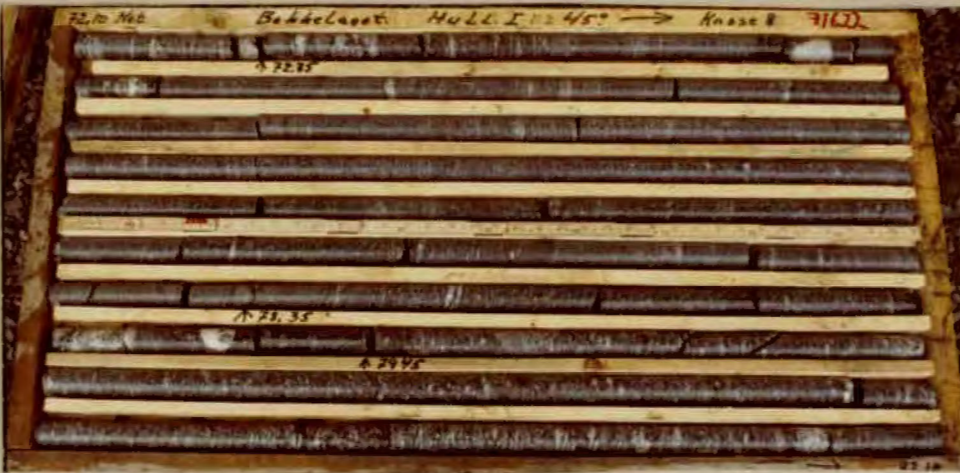
Kasse 8. 72, 10-82, 10m. Gjennomsnittlig RQD=94% Min. RQD=80% (79, 10-80, 10).
