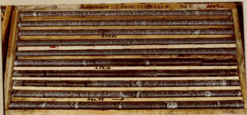
Kasse 6. 52, 10-62, 10m. Gjennomsnittlig RQD=98% Min. RQD=90% (59, 10-60, 10).
