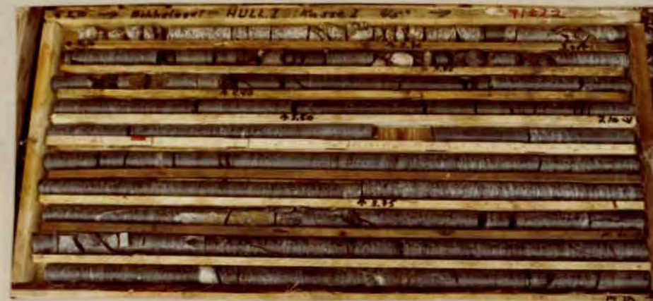
Kasse 1. 2, 10-12, 10m. Gjennomsnittlig RQD=63% Min. RQD=10% (2, 10-3, 10).
