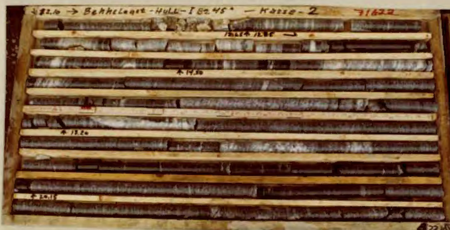
Kasse 2. 12, 10-22, 10m. Gjennomsnittlig RQD=81% Min. RQD=37% (13, 10-14, 10).
