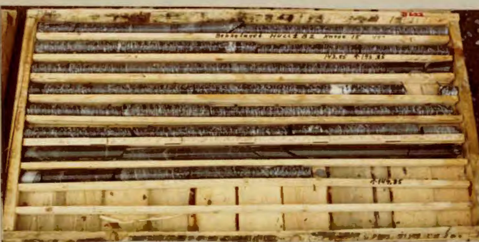
Kasse 15. 142, 10-149, 85m. Gjennomsnittlig RQD=96% Min. RQD=82% (144, 10-145, 10).
