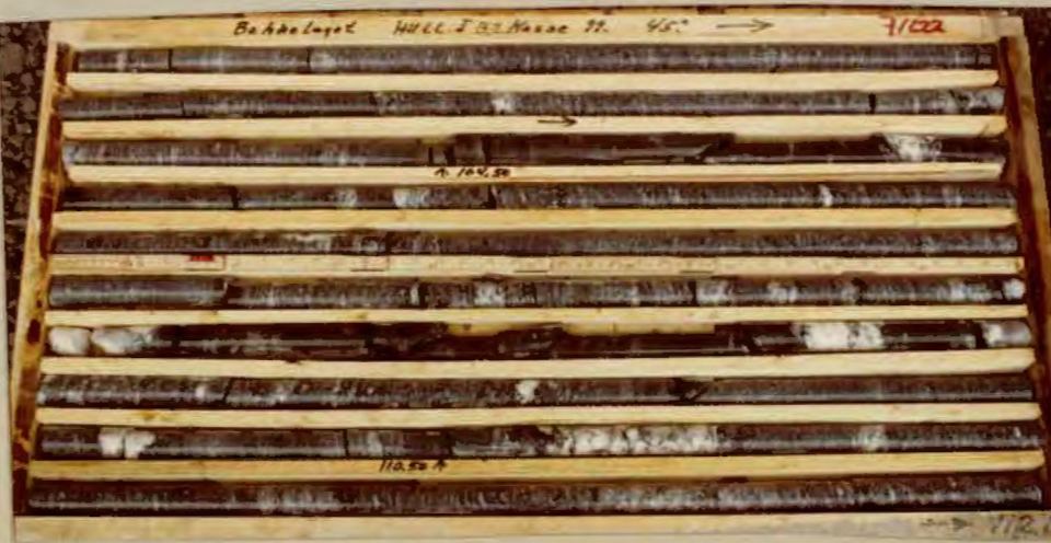
Kasse 11. 102, 10-112, 10m. Gjennomsnittlig RQD=95% Min. RQD=62% (108, 10-109, 10).
