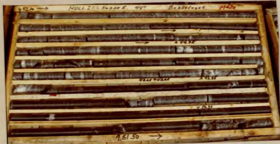
Kasse 5. 42, 10-52, 10m. Gjennomsnittlig RQD=90% Min. RQD=60% (46, 10-47, 10).
