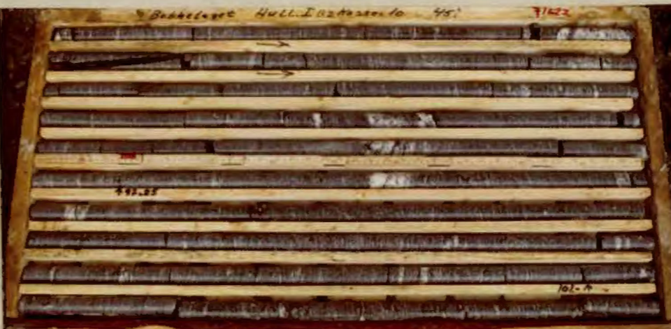
Kasse 10. 92, 10-102, 10m. Gjennomsnittlig RQD=99% Min. RQD=95% (93, 10-94, 10)
