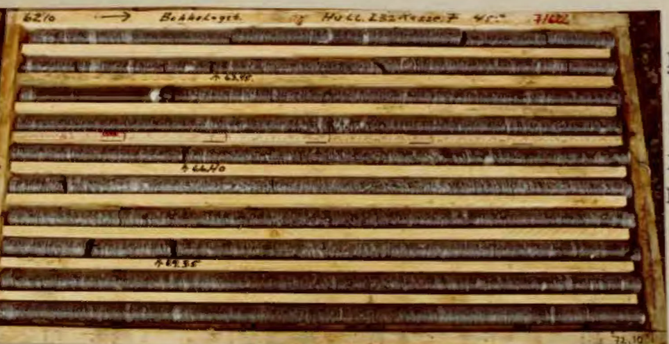
Kasse 7. 62, 10-72, 10m. Gjennomsnittlig RQD=98% Min. RQD=95% (63, 10-64, 10).
