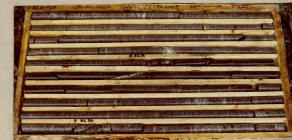
Kasse 9. 82, 10-92, 10m. Gjennomsnittlig RQD=96% Min. RQD=85% (86, 10-87, 10 og 91, 10-92, 10).
