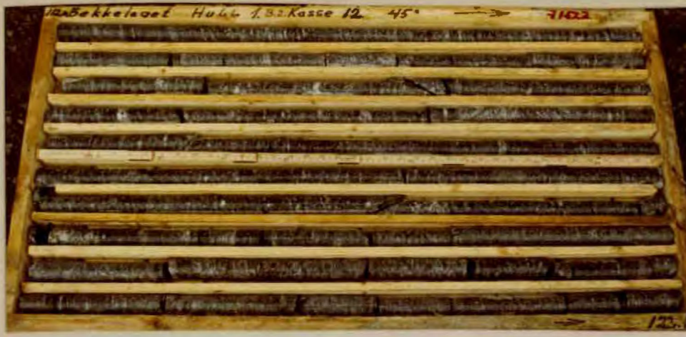
Kasse 12. 112, 10-122, 10m. Gjennomsnittlig RQD=93% Min. RQD=77% (121, 10-122, 10).
