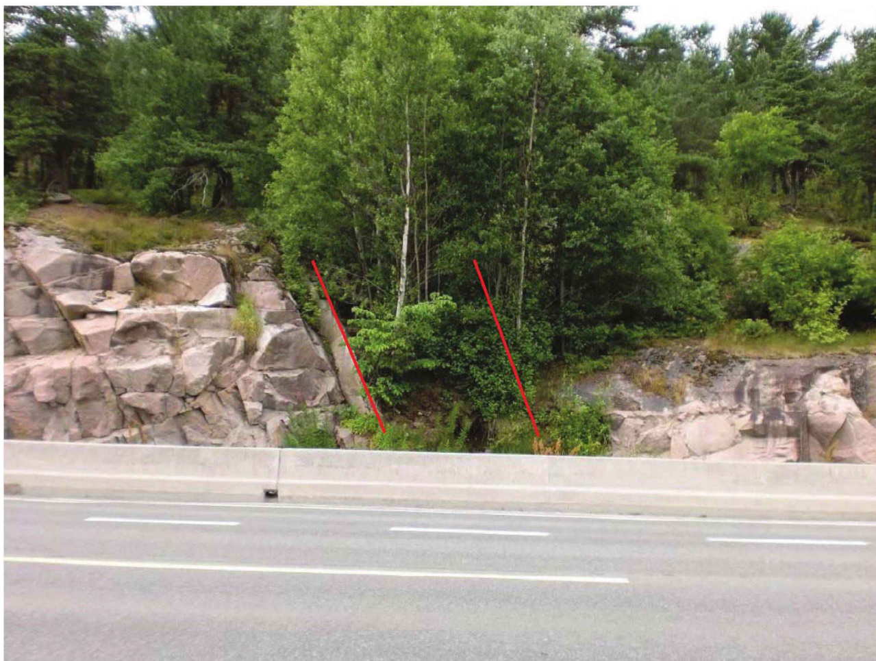
Figur 3: Svaghet 1. Bilden är tagen där S1 skär Trondheimsveien. 307/64 och 387/54 beskriver orientering på respektive röda linje. Den streckade linjens orientering är noterad på annan plats där bättre möjligheter för mätning fanns längre in i skogen. Fotot är taget från södra sidan av Trondheimsveien.
