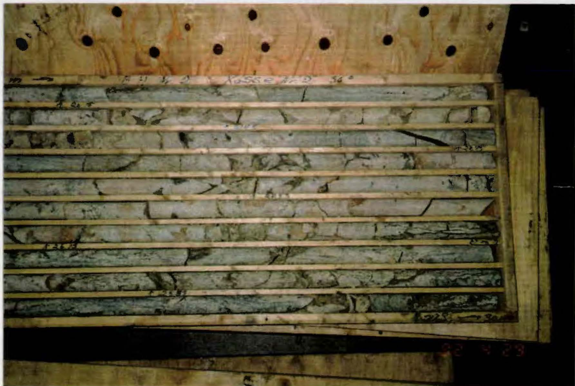
Borhull nr.2, 20 - 30 meter
