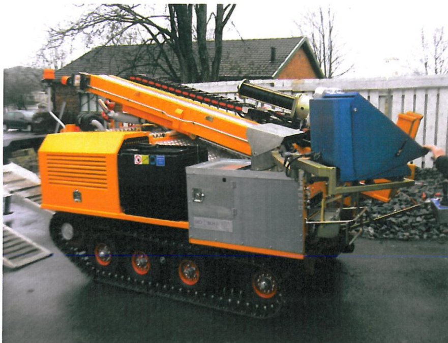
Figur 4-1 Geoteknisk borerigg Geotech 607.
