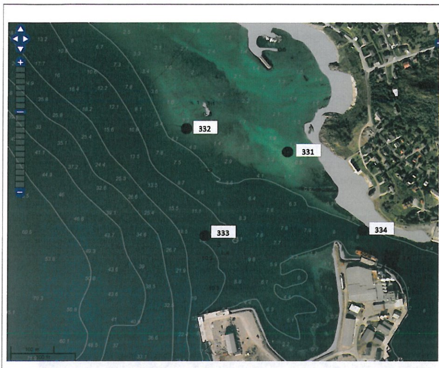
Figur 5-3 Gjennomførte boringer for utdyping.
