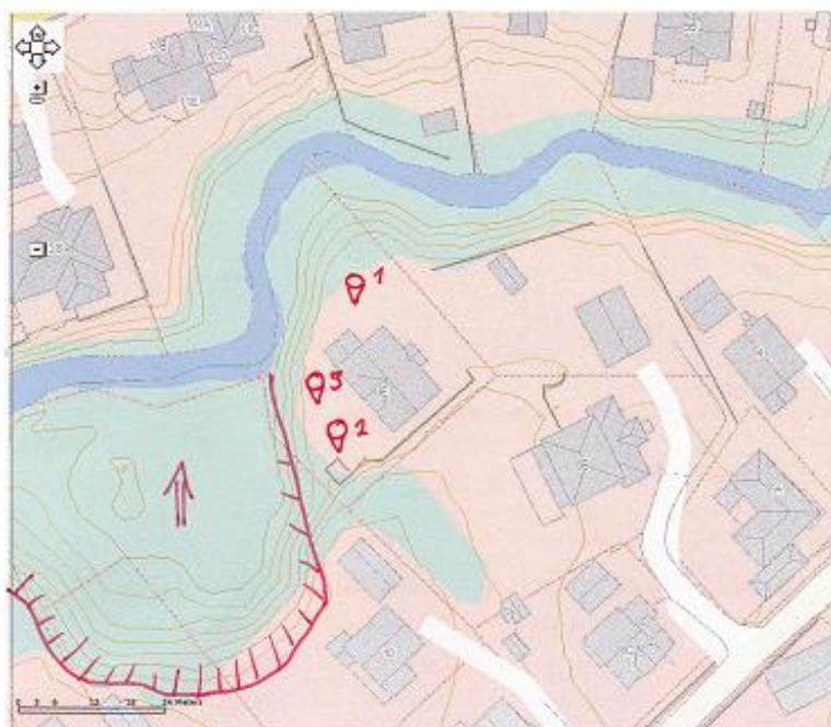
Figur 1. Vikveien 6E lokalisert nær skråningen ned mot Veiabekken. Sonderingspunktene 1, 2 og 3 er markert. Antatt gammel grop etter et kvikkleireskred også inntegnet.
