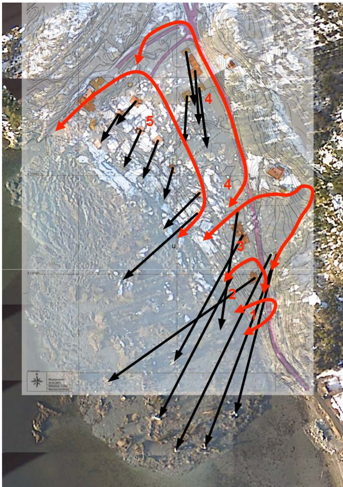
Figur 9 Kattmarka - skredets forflytninger av bygninger
