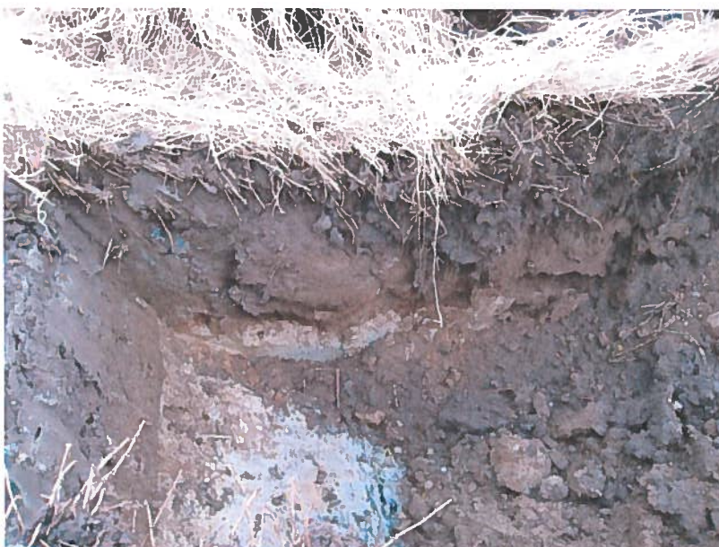
Bilde 2. Jord over sand/grus over meget fast leire i hull 1. Bilde 3. Hele gravehull 1, dybde ca. 2 m.
