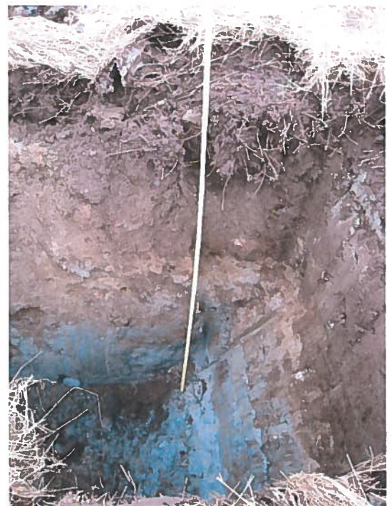
Bilde 2. Jord over sand/grus over meget fast leire i hull 1. Bilde 3. Hele gravehull 1, dybde ca. 2 m.
