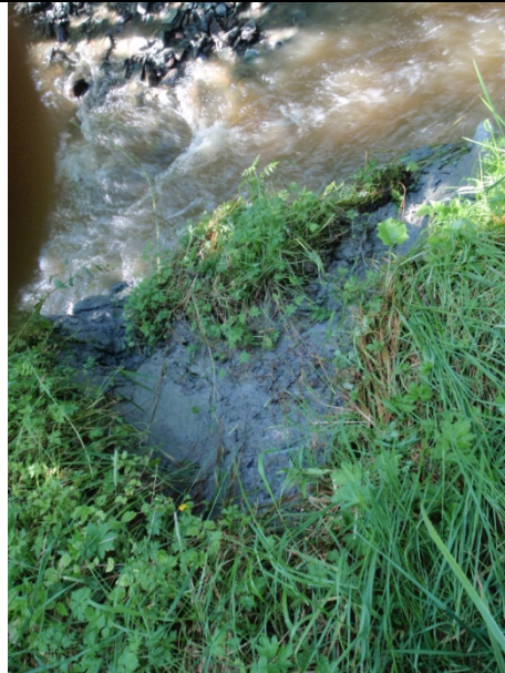
Bilde L 2 Overflateutglidning i leire
