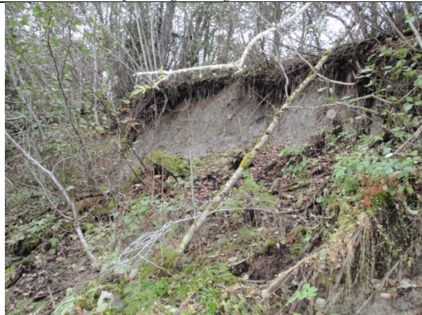
Bilde Le 3 Rotasjonsutglidning østside, 15 m brei
