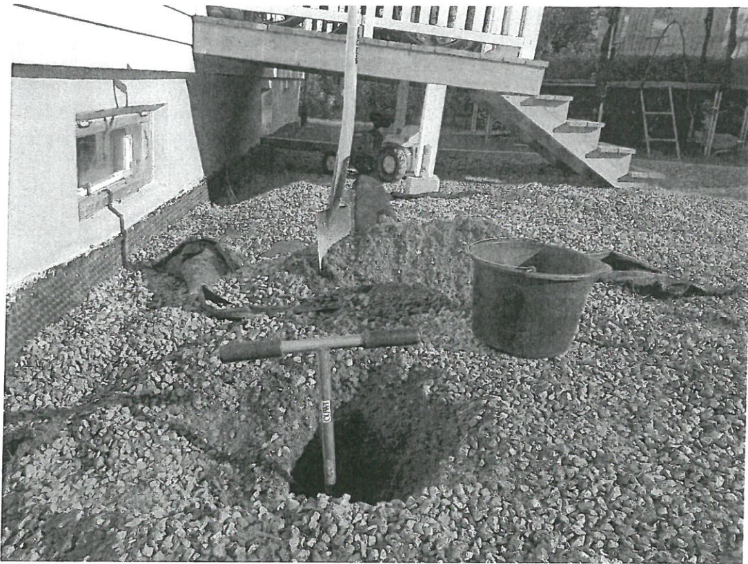
Figur 2 Fra utgraving av overdekningsmasser klargjort for prøvetaking ved bruk av manuelt jordbor.
