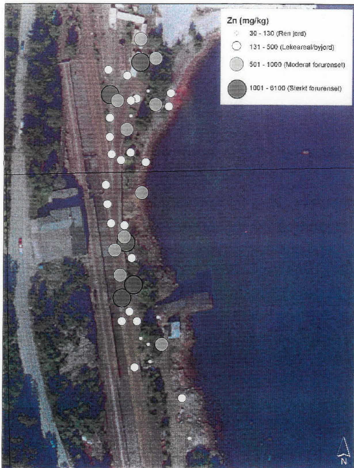
Sink Overflateprøver Bynesveien 30
