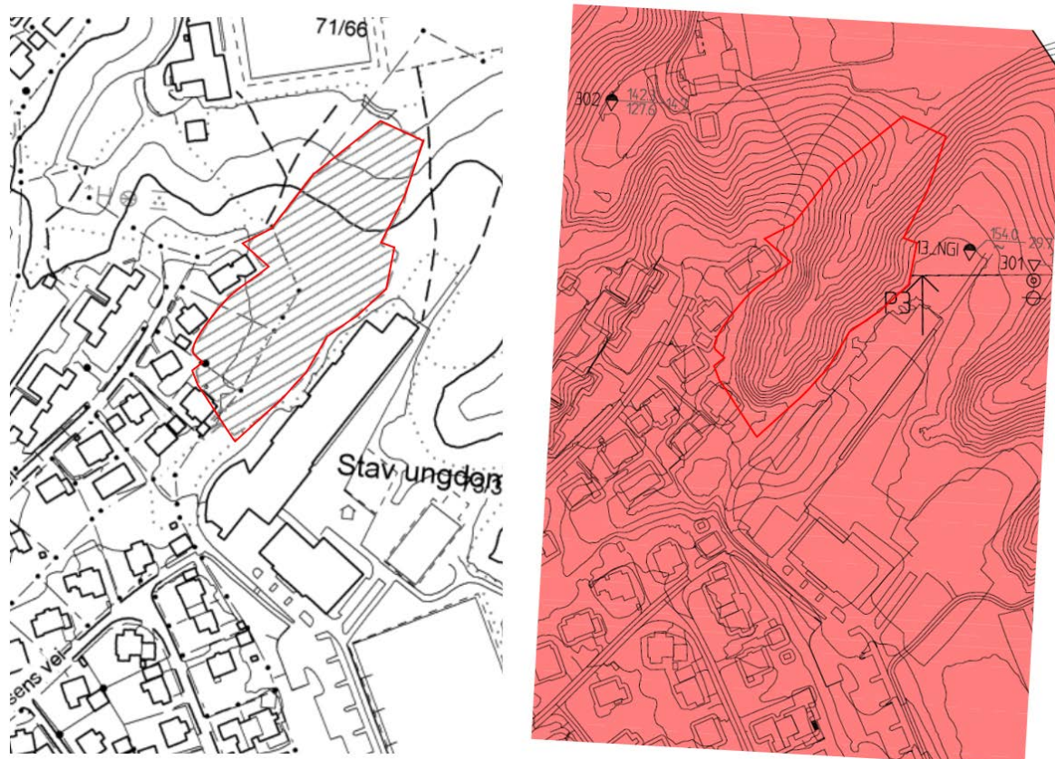
Figur 7 Oppfylling i ravine vest for Stav ungdomsskole. Venstre: Rasterkart ( www.senorge.no ) viser oppfylling (rødt omriss). Høyre: Før oppfylling. Omriss av oppfylling markert (rødt omriss).
